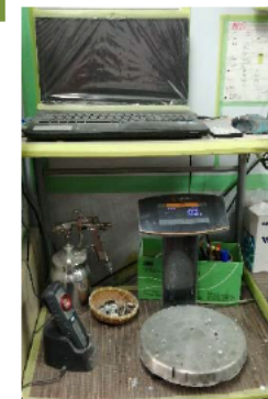
車体の色合いを測定する機器。液晶面を車体に当てて、色の割合を 0.1g 単位で分析。
