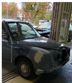
塗装する箇所の色をはがした形で塗装作業に入る。
