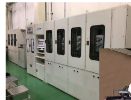
LED-UV インキの自動計量装置。 特色インキなどの調色作業を自動で行う。
