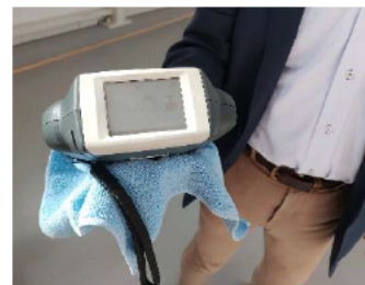
車体の色合いを測定する機器。液晶面を車体に当てて、色の割合を 0.1g 単位で分析。
