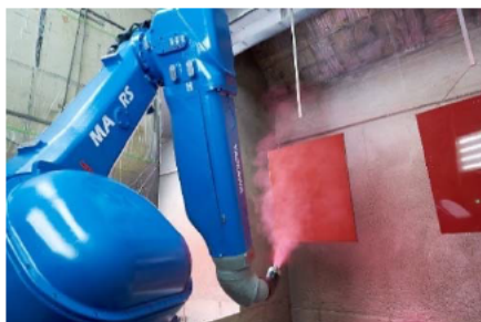
溶剤塗装 (ロボット塗装)
