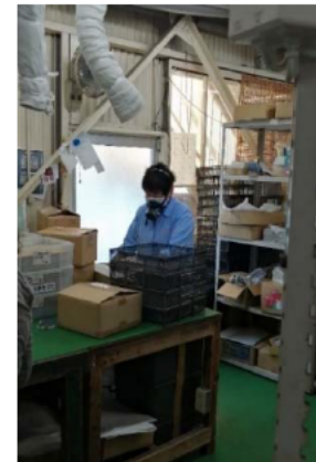
トリクロロエチレン使用の洗浄設備へ材料を設置・回収する担当者は防毒マスクをつけている。
