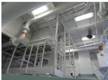
船舶用水性塗料「ALQUA SHIP」で 塗装した船体内部の例
