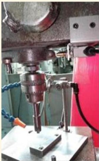
加工の待機中も常にエアブローをしていたものを、ボール盤にスイッチと電磁弁を取り付けて、加工中のみブローするようにしました。これにより年間で16万円の電気代の節約ができました。汎用の設備でも工夫をすることで省エネができるようになります。
