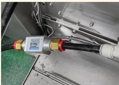
加工設備では切粉や切削油の除去にエアブローを多く使います。連続でのブローをパルスブローにすることでエア消費量を半減できます。
