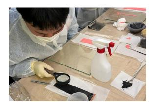
る実験を行いました。負極は黒鉛、正極は擬似的にチョークの粉を用いて、水糊を加え、乳鉢で混ぜ合わせます。銅箔の上に模擬の負極材をアプリケータを用いて塗布し、表面を虫眼鏡で観察すると、どの班もダマが確認できました。実際の電池ではこうしたダマが性能に大きまとを与えるために、どうすればダマなく混錬できるか考察するよう、先生から指摘がありました。続いて疑似セパレータ、疑似正極材を重ね、ストローに巻き付け、筒状の容器に挿入して、実験は終了です。
