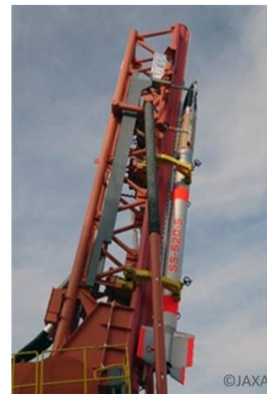
世界最小の軌道ロケット 高さ9.54 m、直径0.52 m
