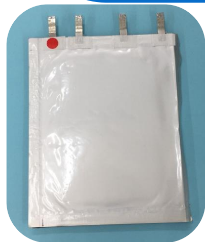
交流電池 バイオード（正極と負極一体になったもの）を 用いた、交流での充放電が可能な蓄電池 （特許技術）
