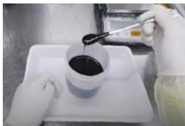
電池試作VR動画：電極スラリーの様子
