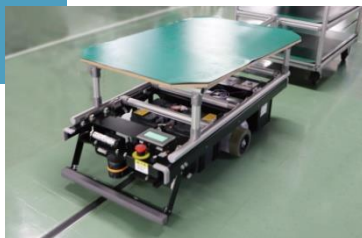
自社で独自設計・製作したAGV
