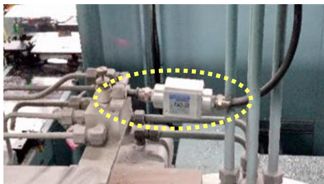
※1：エアブローをパルス化する装置を設置し、消費電力の抑制に取り組んでいる
