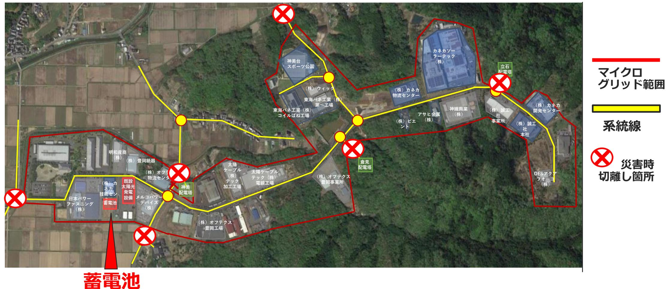
※太陽光発電約 2 MW、蓄電池約 2 MW-6MWhの設備を経産省補助金を活用して導入
