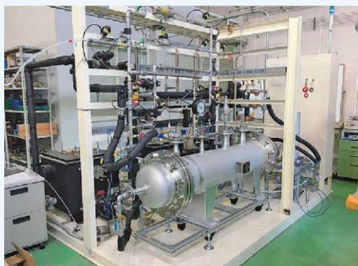
▲水素低圧吸蔵容器と吸蔵・放出性能評価装置
