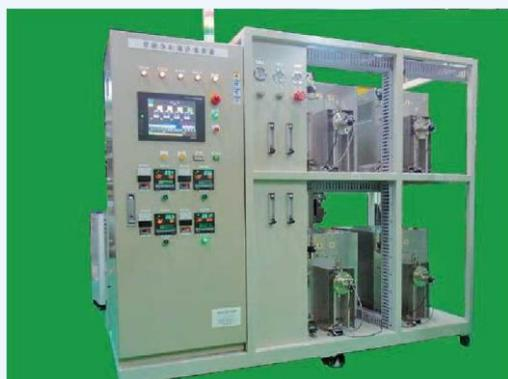
▲酸化還元雰囲気中で電気的特性を評価する装置
