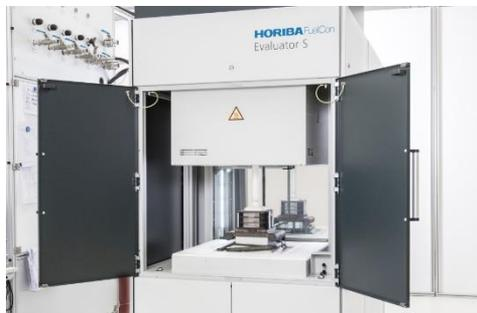
再生可能エネルギーを用いた水電解によるグリーン水素の製造では、その中心となる水電解装置の性能向上・耐久性向上・低コストの実現が重要で、近年ますます研究・開発が加速しています。例えば電解セルの研究・開発の加速には電極・電解質・セパレーターの素材分析などに加え、様々な試験環境での総合評価が必要となります。HORIBAは開発対象となるPEMやSOECのセル・スタックに対して各種ガスを流量・温度・湿度・圧力を制御して供給する事で総合的に性能評価ができる試験設備をグローバルに供給します。
