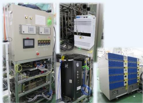
▲水蒸気電解試験装置
