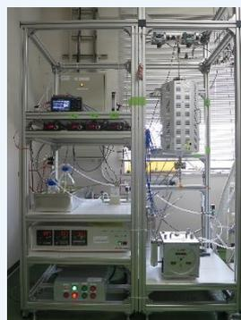
▲アンモニア分解反応試験装置
