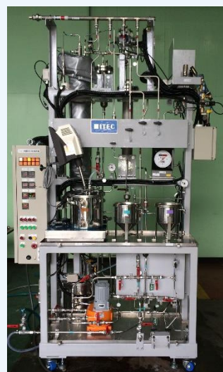
▲プロトタイプ：反応時間、反応温度など原料特有の把握をし、量産機へのスケールアップ化につなげる
