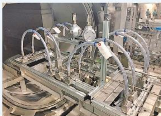
▲水素インパルス試験（岩谷産業 中央研究所での耐久試験）
