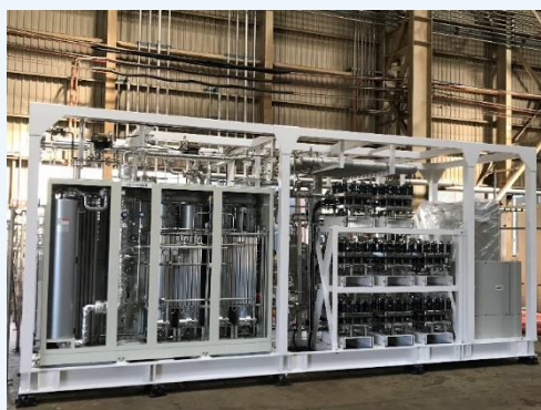
▲水素発生装置 HHOG スキッドマウントタイプタイプ 50Nm 3 /h
