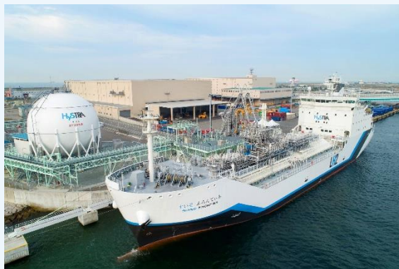
▲日豪間での液化水素サプライチェーン構築に向け神戸空港島に建設した実証用の液化水素貯蔵・揚荷設備と液化水素運搬船「すいそ ふろんていあ」
