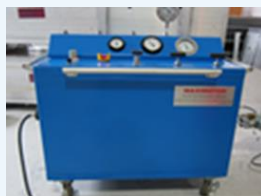
▲高圧水素配管・容器の耐圧試験に用いる昇圧機
