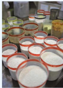
▲独自の配合設計で高圧水素のシールを実現
